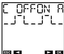
Allumage au coucher du soleil, coupure nocturne réglable (Exemple : coupure de 23h à 5h), puis extinction au lever du soleil.
